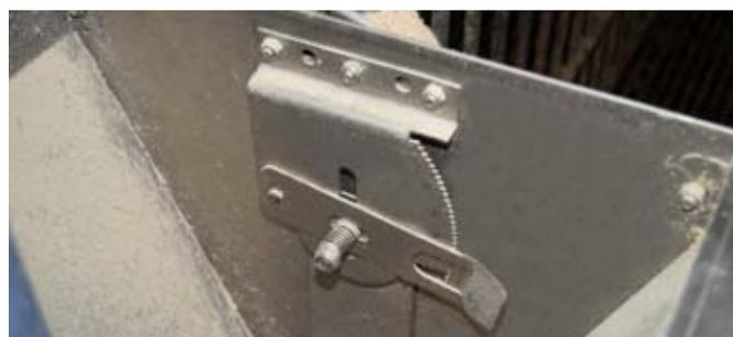
调节系统只有两个调节器，提供快速，精准，持续的饲料开启控制
